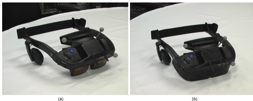
Figura 3.1: Visor estereoscópico acoplado a marcadores do sistema de captura de movimento. Em (a) o visor está preparado para Realidade Aumentada e em (b) para Realidade Virtual.
