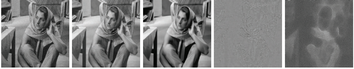
Figura 1.14: (a) Imagem original; (b) imagem restaurada. Decomposição nas três componentes: (c) cartoon ; (d) textura e (e) ruído. Fonte: Casaca et al [CB10].
